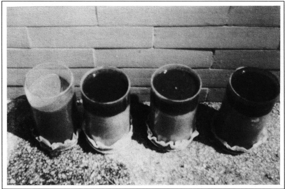
Figura 3 - Sulla sabbia filtrata e lavata si sono versati 100 cc di acqua o di fanghi (primari, secondari e digeriti). L'acqua pura percola immediatamente in profondità (a sinistra) mentre l'analoga quantità di acqua contenuta nei tre tipi di fanghi resta in superficie, trattenutavi dall'humus unitamente ai nutrienti (ma anche ai contaminanti batteriologici e chimici se ci sono). La sabbia così trattata diventa fertile.
